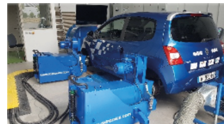
Banc d'essai dynamométrique et émulateur batterie (CPER RITMEA)
