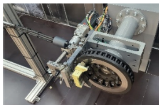
Banc de freinage ferroviaire (projet ADEME Breaq)
