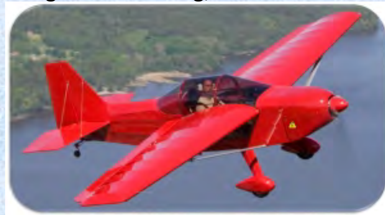
ELECTRAVIA : Avion de voltige (100cv) Moteur 35 kg batteries 55kg, autonomie 35 min
