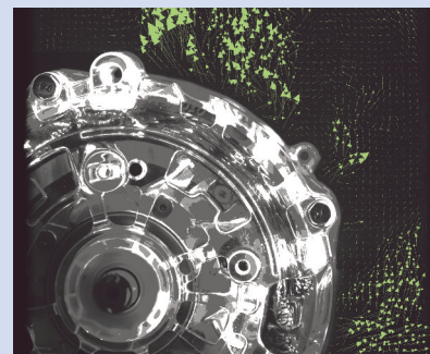
Mesures par vélocimétrie par image de particules des écoulements d'air sortant d'un alterno-démarreur
